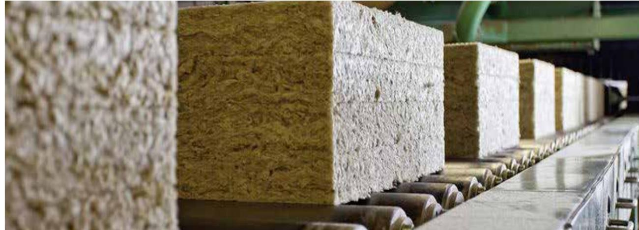
岩棉生产工艺中，树脂棉毡出沉降室后，经加压辊预压进入固化炉进行热处理，使树脂脱水固化，成为结构和形状固定的产品。这是矿棉渣、岩棉绝热板制造工艺的最重要步骤。
