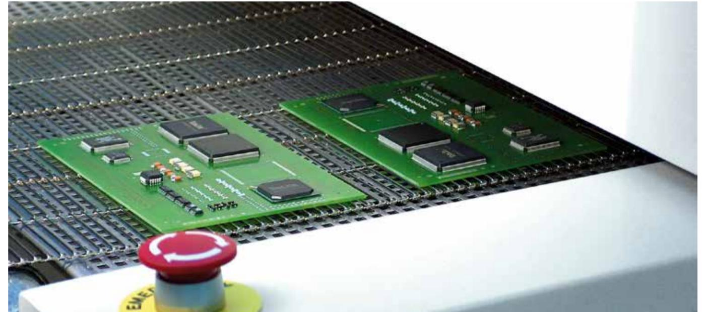
SMT是表面组装技术, 是目前电子组装行业里最流行的一种技术和工艺。在 SMT 生产线中, 回流焊和波峰焊是其中所占比例较大和很重要的一个环节。
