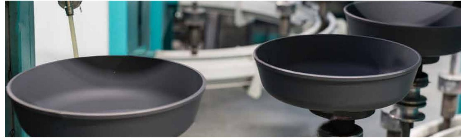
不锈钢高压锅表面的特氟龙涂层，需要在650°C以上的高温隧道炉进行固化。
