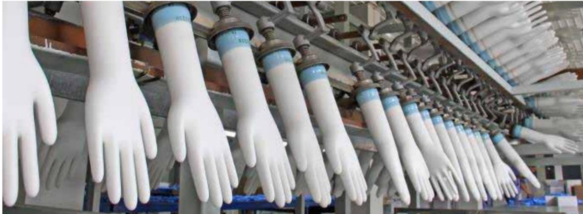
PVC手套广泛应用于医疗卫生、食品生产等领域,需求量大,我国是全球主要的PVC手套生产国。在正常生产状况下,生产线上的手模自动进入浸渍槽,粘附乳液的手模依次从浸渍槽中出来,行进中不断转动,以使手模表面上的乳液均匀;多余的乳液垂滴下来经收集槽返回浸渍槽中。垂滴完多余乳液的手模随生产线移动进入烘箱,烘箱温度一般控制在230°C - 250°C,少数极端工况温度高达280°C,在此条件下,手模上的乳液熟化成型。
