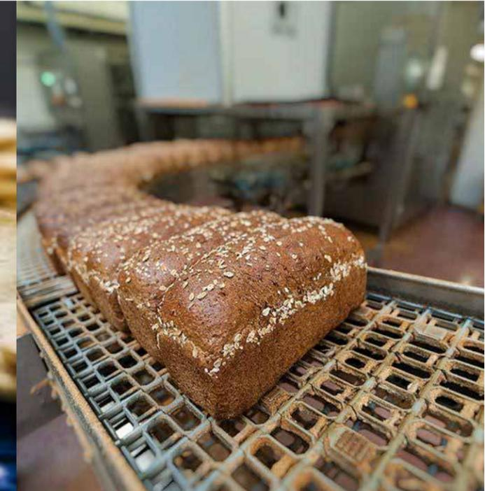
面包烘焙是食品烘培加工中的特例，加工过程中会经历高湿度和高温，面火温度有的大于275°C，底火温度高于245°C，还有酸碱腐蚀，远远超出了食品级润滑油能够承受的技术指标限制，对润滑剂选择是一个很大的挑战。
